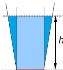
Die Gewichtskraft des Teils der Wassermenge, die nicht über der Membran liegt, wirkt nur auf den Glasrand und nicht direkt auf die Membran. Da die Kräfte des Glasrandes vom Kraftmesser nicht erfasst werden, liefert die Gewichtskraft dieses Wasserteils keinen Beitrag zur Bodendruckkraft.
